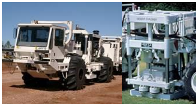
Figura 3 – Equipamento utilizado para aquisição de dados sísmicos
