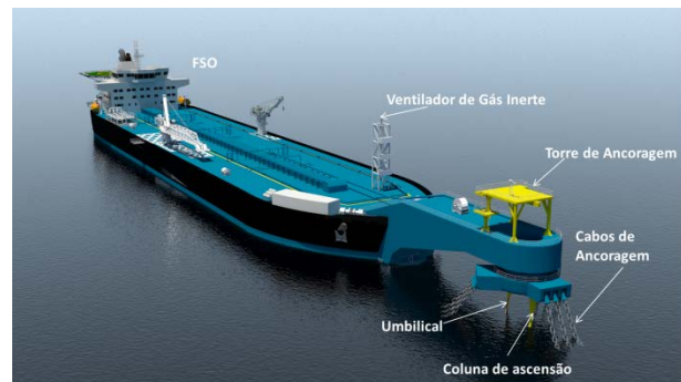
Figura 3: FSO com Torre de Ancoragem
