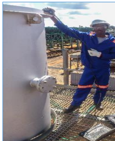
Medição das emissões da chaminé de queima da fábrica como base para a modelação dos impactos cumulativos da poluição do ar.
